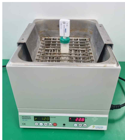
그림 16 배양기에 코니컬 튜브와 센서가 꽂혀 있는 사진
